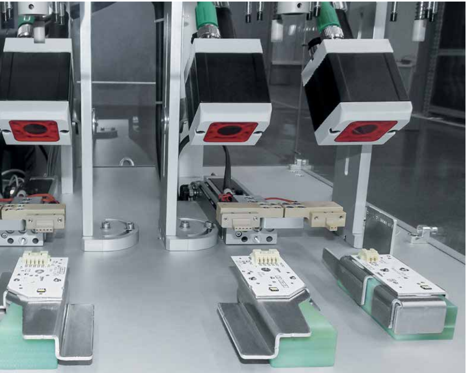
Датчик технического зрения SBSI в испытательной системе: эксперты в области автоматизации из компании IMI Electronics используют более 100 таких датчиков для обеспечения отслеживаемости
