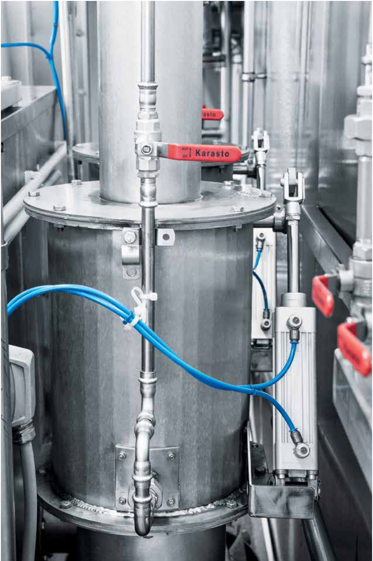
Цилиндры DSBC по ISO с самонастраивающейся системой пневматического демпфирования PPS регулируют клапаны горячего пара и копильную камеру
