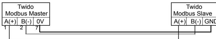
Соединение с терминальным блоком
