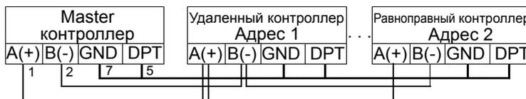
Соединение терминального блока
