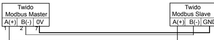
Соединение с терминальным блоком
