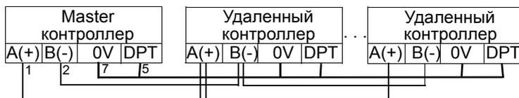
Соединение терминального блока
