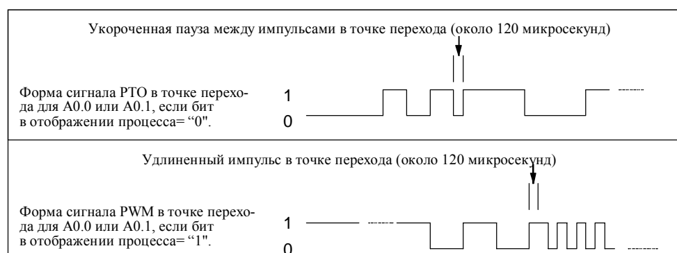
Рис. 9-53. Пример формы импульсных последовательностей на A0.0 или A0.1
