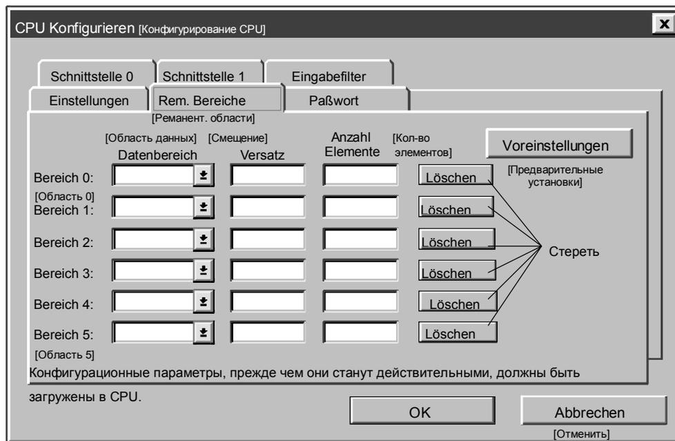
Рис. 6-17. Конфигурирование реманентных областей в памяти CPU
