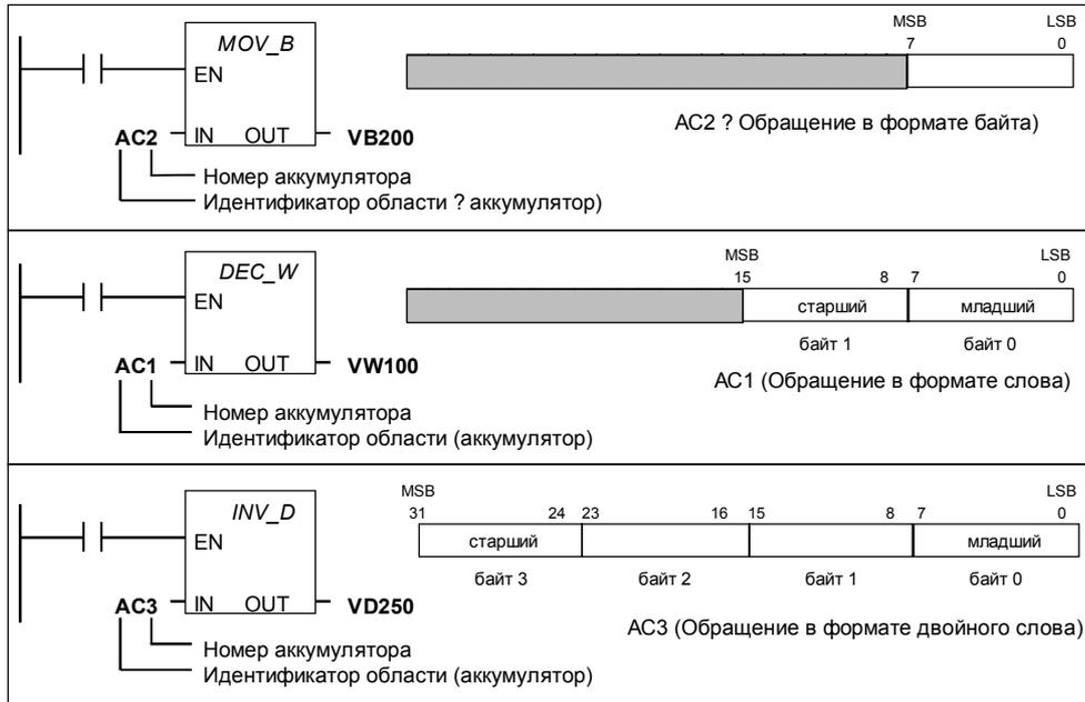
Рис. 6-7. Адресация аккумуляторов
