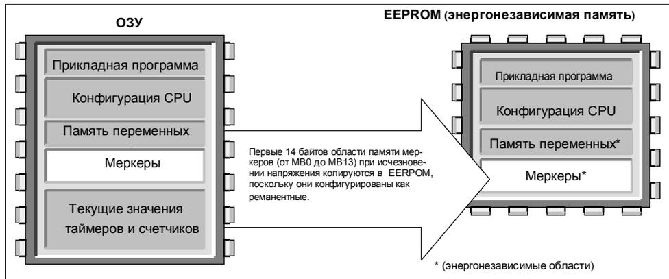
Рис. 6-13. Сохранение меркеров в EEPROM при исчезновении напряжения
