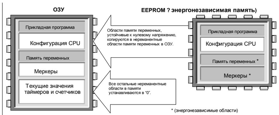
Рис. 6-15. Восстановление данных при пуске (данные были буферизованы в ОЗУ)
