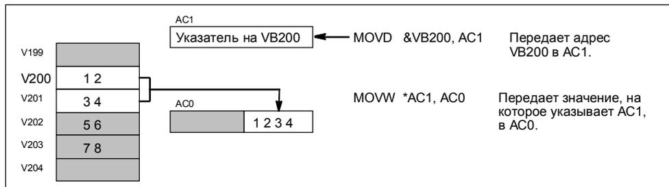
Рис. 6-9. Применение указателя для косвенной адресации
