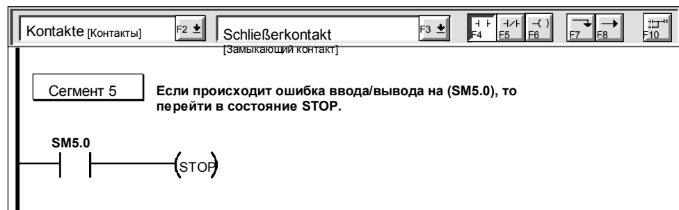
Рис. 5-18. Распознавание сбойных ситуаций, связанных с незначительными ошибками, в прикладной программе
