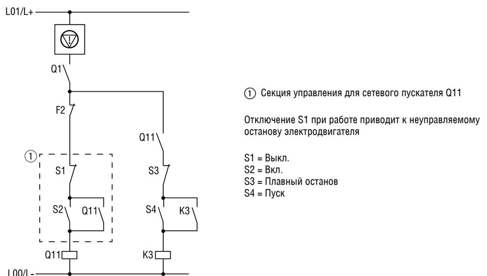
Рисунок 75. Секция управления с сетевым пускателем
