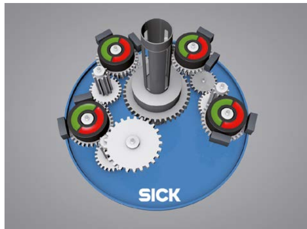
Beispiel: magnetischer Multiturn mit Getriebe.
