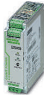
Источник питания, с лаковым покрытием печатной платы, однофазный, 24 В пост. тока, 5 А
