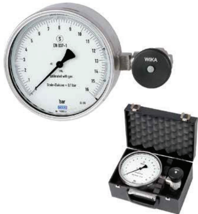
Тестовый манометр, модель 332.11 снизу: в сервисном чемодане
