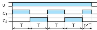
**(SW) Симметричный повтор цикла (начал.импульс ВКЛ).**
