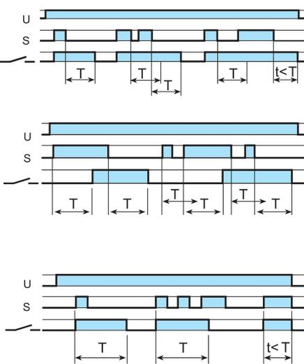
**(BE) Задержка отключения с управляющим сигналом.**
