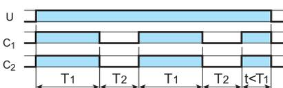
**(LI) Ассиметричный повтор цикла (начальный импульс ВКЛ).**
