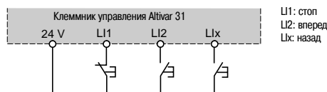
Схема соединений при 3-проводном управлении
