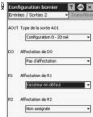
Конфигурирование реле неисправности с помощью PowerSuite для ППК
