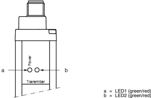
**Fig. 5.1-1:** Transmitter status displays
