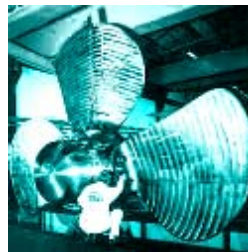
Гребной винт - настройка шага
