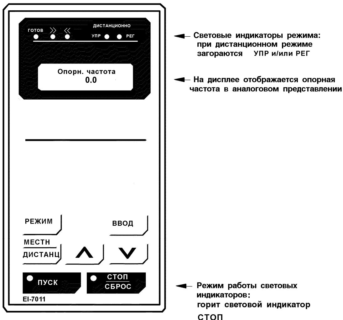
Рис. 14 Состояние пульта управления при включении питания.
