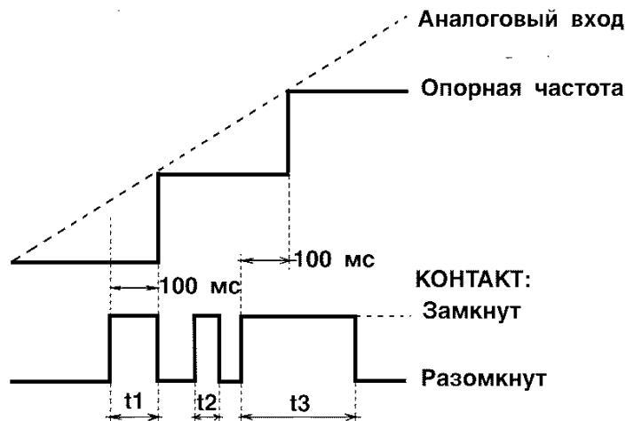
Примечание:  $t_1$ ,  $t_3$  - опорная частота при 100 мс или более
