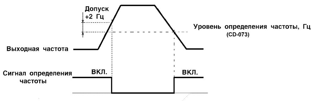
**(б) Определение частоты 2 (Выходная частота  $\geq$  "Уровня определения частоты")**
