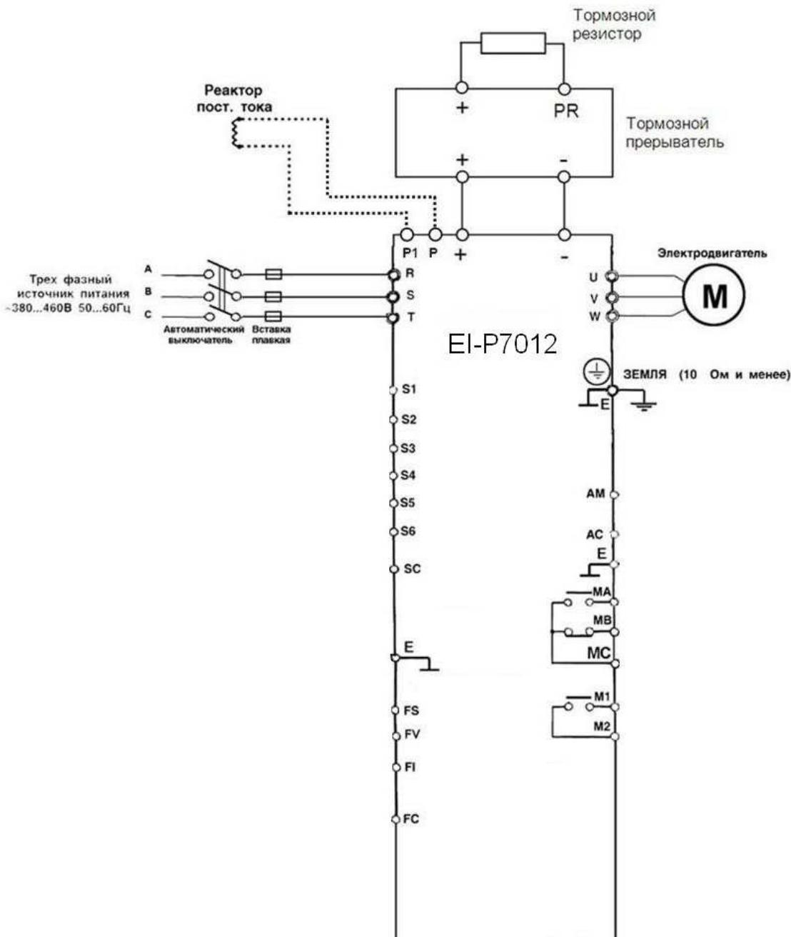
1. При установке реактора постоянного тока удалите перемычку между клеммами Р и Р1 и подсоедините реактор к этим клеммам (модели 030Н...050Н).
