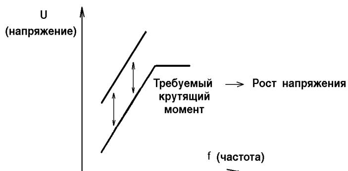
Обычно нет необходимости в настройке значения компенсации крутящего момента (CD-067), соответствующего уставке "1,0". В случае, когда велико расстояние от электродвигателя до преобразователя (длина электропроводки) или, когда в результате работы двигателя возникает вибрация, измените величину компенсации крутящего момента.
