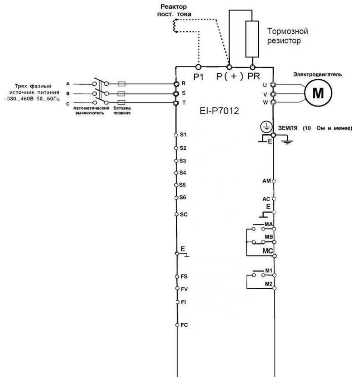
1. При установке реактора постоянного тока удалите перемычку между клеммами P (+) и P1 и подсоедините реактор к этим клеммам.
