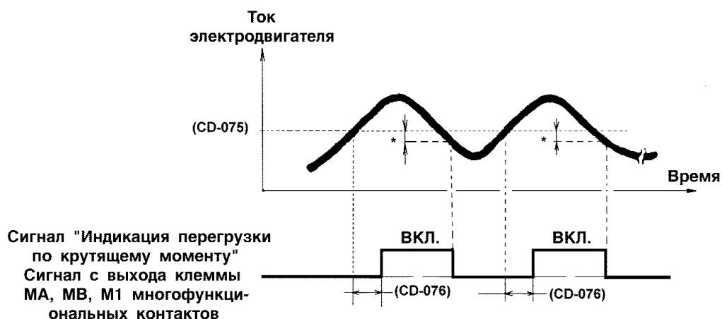
\* Токовый гистерезис во время индикации перегрузки по крутящему моменту составляет порядка 5% от уровня потребляемого тока преобразователя.
