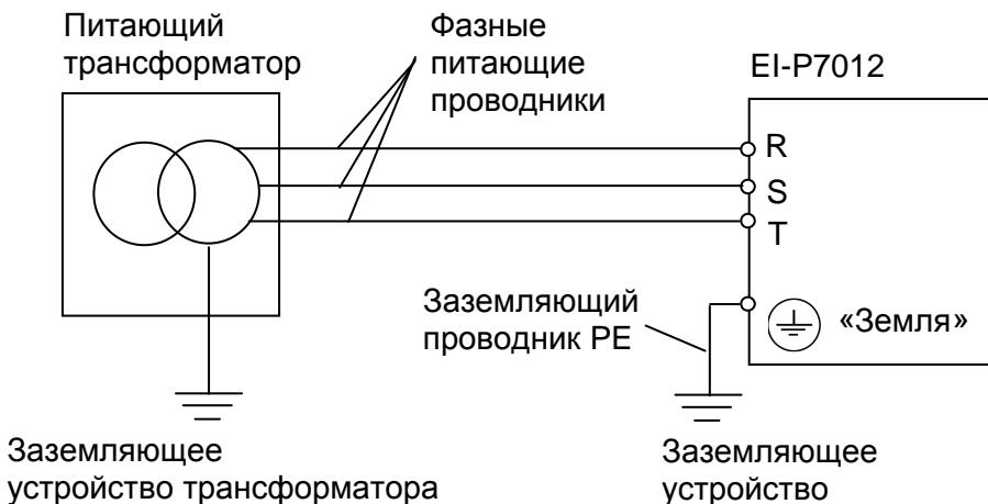
**!** При использовании любой из вышеуказанных систем заземления запрещается подсоединять к клемме «Земля» преобразователя частоты EI-P7012 нейтральный рабочий проводник (N) или совмещенный нейтральный рабочий и защитный проводник (PEN), соединенные со средней точкой питающего трансформатора.
