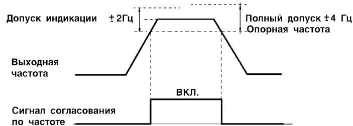
(в) Пример уставки "Сигнала согласования по требуемой частоте"
