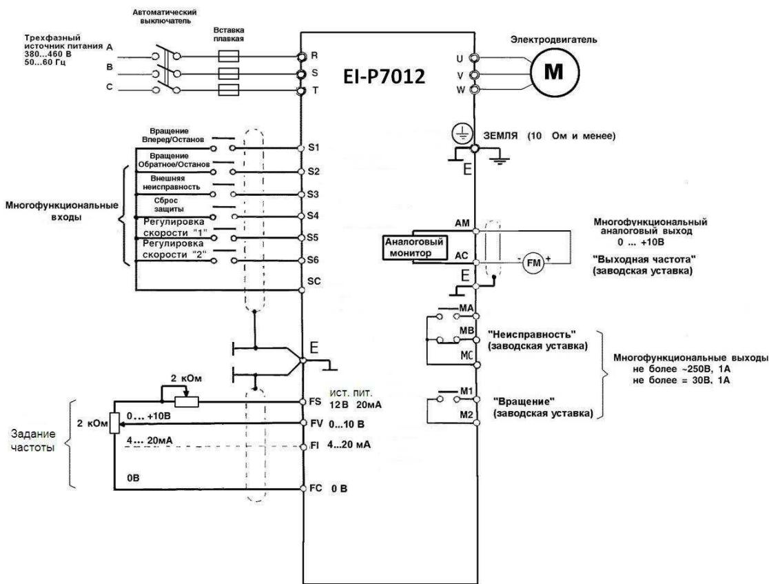
Рис. 9. Схема подсоединения.
