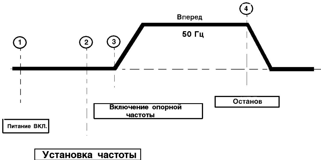
Рис. 16. Последовательность действий при подаче сигналов с клемм управления.
