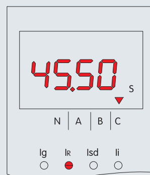
Состояние запроса о срабатывании - время срабатывания
