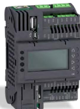
Контроллеры семейства Modicon M171/M172 предназначены для обеспечения гибкой и экономичной автоматизации и могут с легкостью использоваться в следующих решениях:
