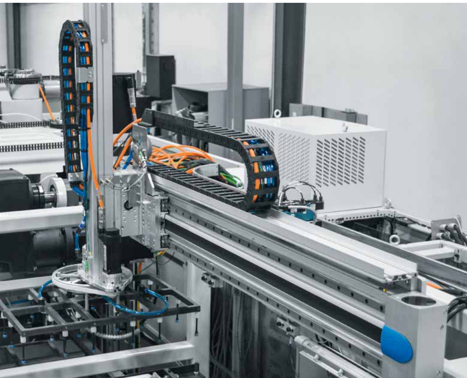
Два привода, два двигателя, принадлежности для укладки кабеля – готово: эта система перемещения Festo работает в GN800 надежно и эффективно.
