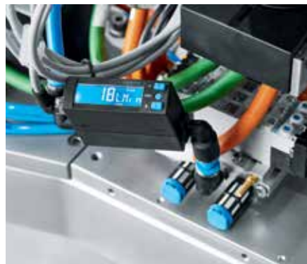
Датчик расхода SFAN быстро и очень точно измеряет давление в системе фиксации в нулевой точке.
