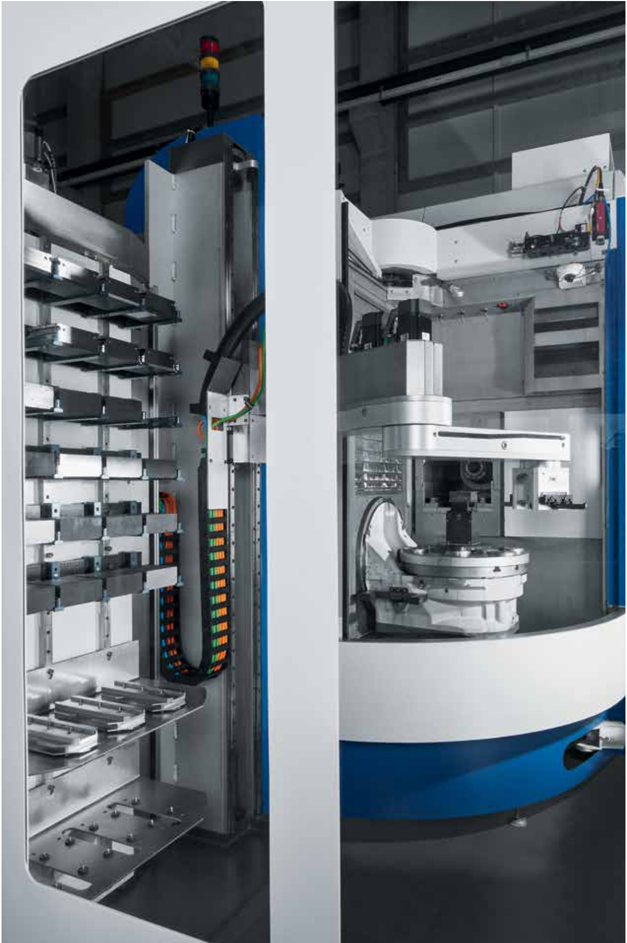
Zerobot 100 V: система автоматизации с удивительно гибким роботом-погрузчиком для станков.
