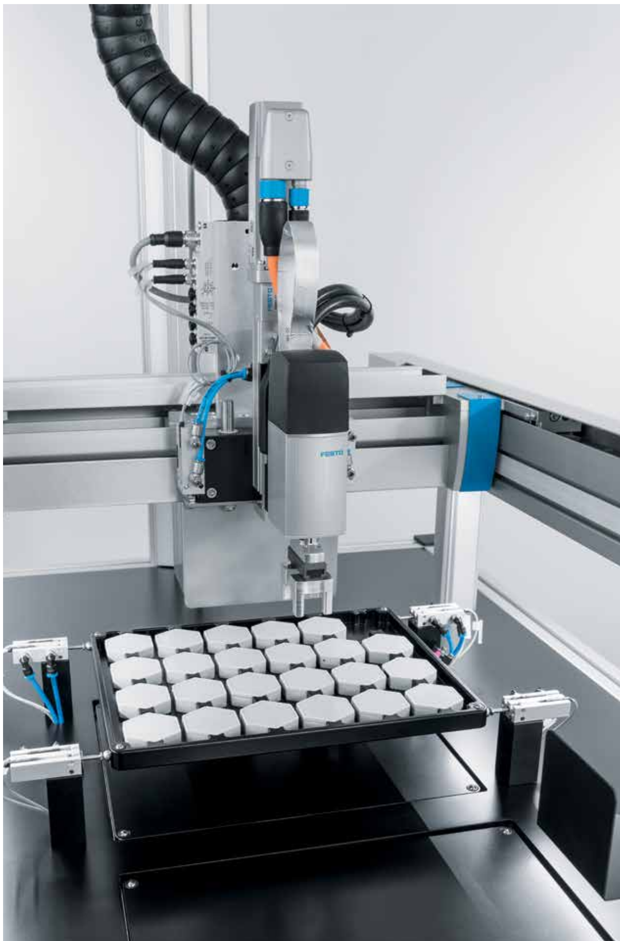
Единая комплексная система для персонификации USB-накопителей: новая платформа автоматизации от Festo содержит все, что нужно для конструирования и эксплуатации таких установок, – от механики, электрики, электроники и программного обеспечения до унифицированных инструментов проектирования.
