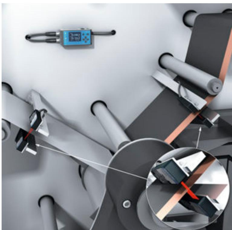
Высокоточное определение кромки полотна материала, например, при производстве батарей
