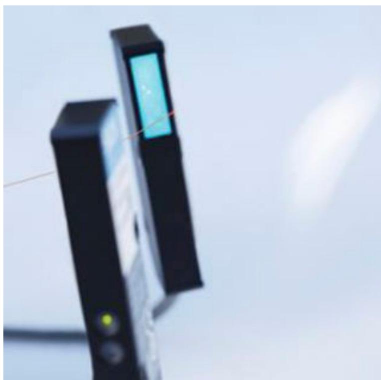
Очень точное измерение диаметра мельчайших объектов, например, диаметра жилы провода
