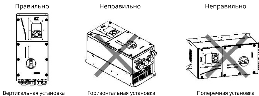
Рис 4.1 Ориентация ПЧ при установке
