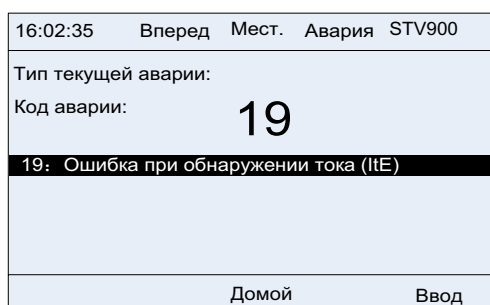
Рис 5.7 Состояние дисплея при сигнализации неисправности ПЧ
