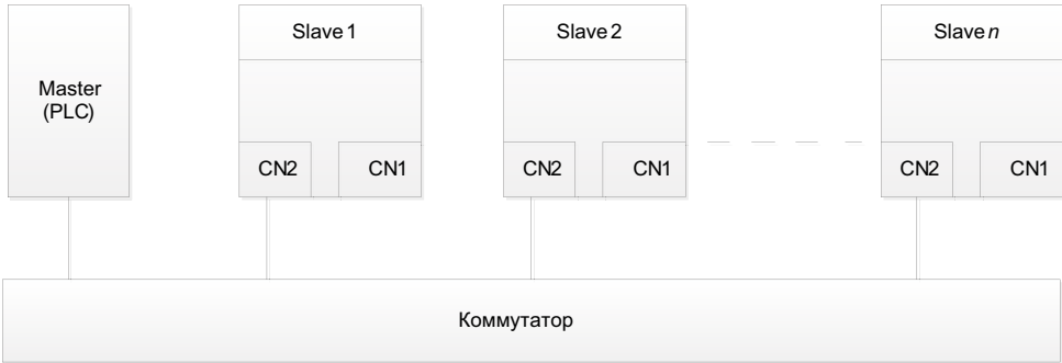
Рисунок А.9 Электрическая схема подключения для топологии "звезда"
