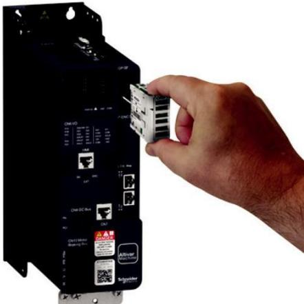
Вставка релейного модуля VW3A3204 в слот GP-SF преобразователя ATV340 с Ethernet ATV340U07N4E.
