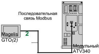
Пример соединения модульного преобразователя ATV340 с интерфейсом Magelis GTO через последовательную связь Modbus
