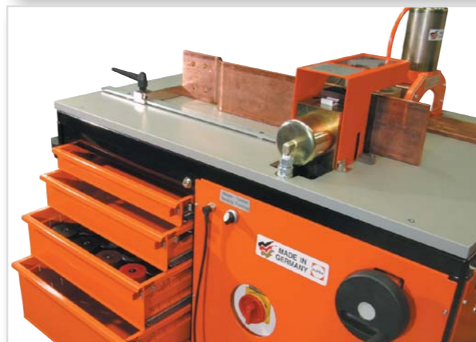
В тележке предусмотрено 4 выдвижных ящика для инструмента со специальными отделениями для пуансонов и матриц
