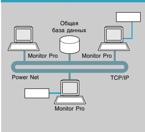
Программное обеспечение Monitor Pro обладает встроенной многостанционной функцией "клиент-сервер" PowerNet. Она служит для разработки приложений с разделением данных между несколькими диспетчерскими станциями. Каждую станцию можно объявить сервером или клиентом других станций сети.
