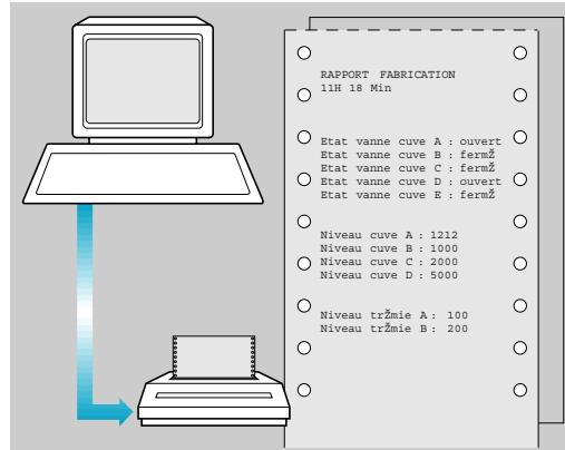
Любое средство диспетчеризации или производственного контроля должно не только регистрировать изменения, состояние производственного процесса и контролировать работу прикладной программы, но и обеспечивать распечатку сводного отчета по этим данным.
