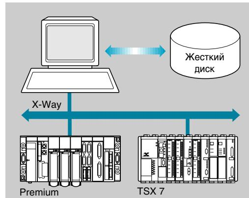
Данная функция важна для монтажа и пуска производственных линий гибких технологических процессов. Возможность интеграции программного обеспечения Monitor Pro в систему связи X-Way позволяет загружать программы на удаленную машину, с удаленной машины, а также сравнивать программы на различных модульных ПЛК, программируемых на языках PL-3 и PL-7. Она также используется для загрузки и сопоставления внутренних данных.
