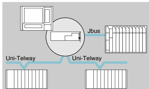
Все стандартные конфигурации поддерживают подключение к последовательному порту по протоколу Uni-TE или Jbus/Modbus.
