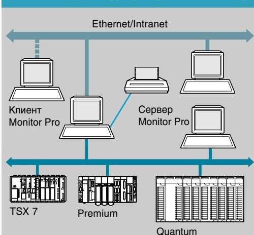
Клиентская архитектура обеспечивает надежный распределенный и удаленный доступ при помощи OPC к серверам в сетях по протоколу TCP/IP и Интернете. Клиенты получают доступ к имеющимся в системе прикладным программам и возможность управлять ими. Клиентские станции независимы друг от друга, поэтому локальный графический интерфейс можно легко модифицировать, не внося изменений в приложения, выполняемые на сервере или других клиентских машинах.
