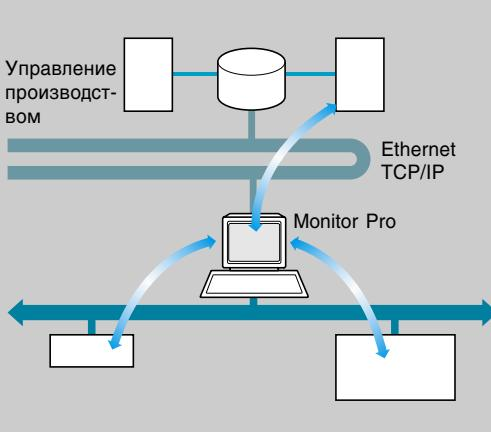
Возможность подключения Monitor Pro к системам MES достигается за счет применения технологий OLE и Active X, а также стандартных форматов баз данных.
