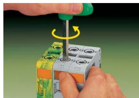
Повернуть шестигранный ключ против часовой стрелки влево. При открытом вводном отверстии утопить фиксатор до упора.
