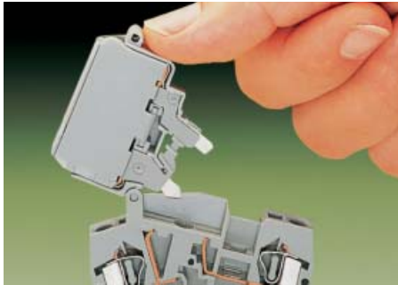
Перед заменой предохранителя откинуть его держатель в заднее положение до фиксации
